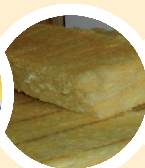
maty i płyty izolacyjne
